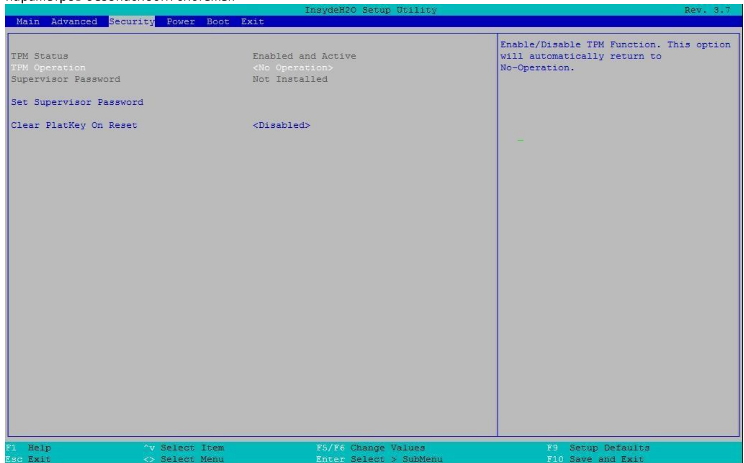
Рисунок 26. Параметры безопасности настройки BIOS
