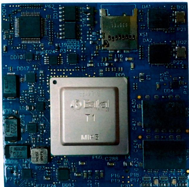
Процессорные модули MR-BT1 значительно упрощают проектирование устройств на основе процессоров «Байкал-Т1», сокращая время, затраты и риски при разработке новых продуктов. Модули MR-BT1 могут применяться во встроенных системах управления наземного, морского и воздушного транспорта, в индустриальном оборудовании, функционирующем в условиях производственных цехов, медицинском и телекоммуникационном оборудовании.
