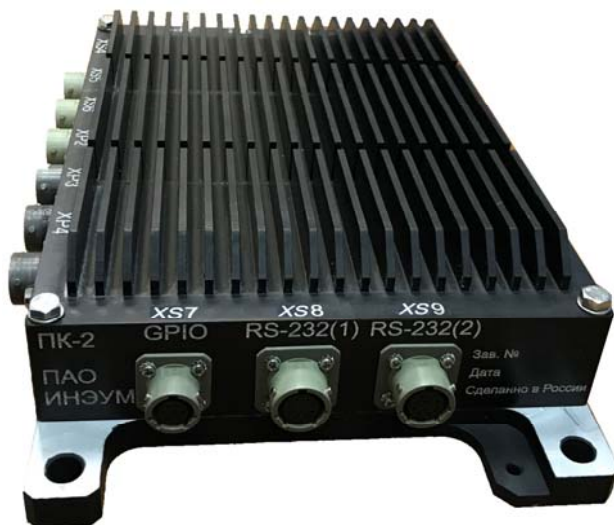
Рисунок 2.5 - Расположение интерфейсных разъемов на корпусе ПК-2 (вид справа)
