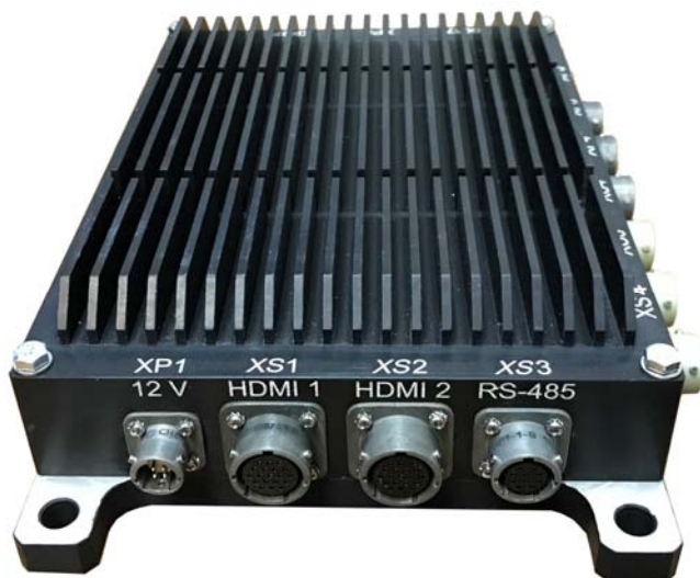
Рисунок 2.4 - Расположение интерфейсных разъемов на корпусе ПК-2 (вид слева)
