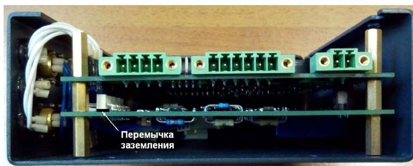
Рисунок 1 - Расположение переключки заземления общего провода аналоговых входов.
